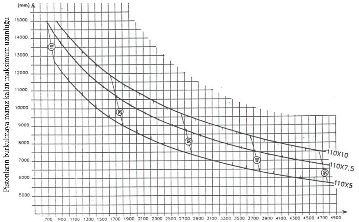
Çizelge 10. Piston çapı 110 mm için burkulma mukavemeti
